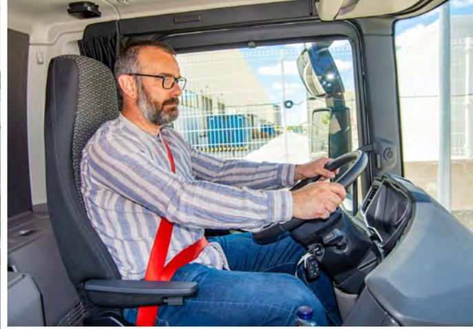
La cabina y el puesto de conducción son idénticos a los de los camiones diésel; únicamente hay diferencias en la información que muestra el cuadro de instrumentos y en las funciones de la palanca del lado derecho del volante, que en los eléctricos gestiona el sistema de recuperación de energía, que hace las funciones de un potente freno auxiliar.
