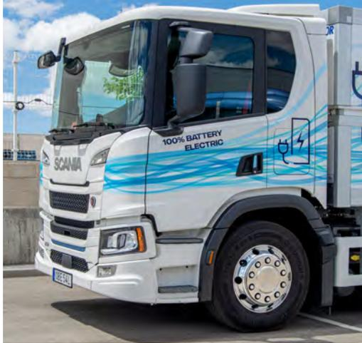
*El equipo eléctrico del camión incluye una toma de fuerza de 60 kW, que permite accionar, por ejemplo, la trampilla trasera, y sirve también para activar el sistema de elevación de la caja de la carrocería, de altura variable, un equipo muy habitual en Suecia.*
