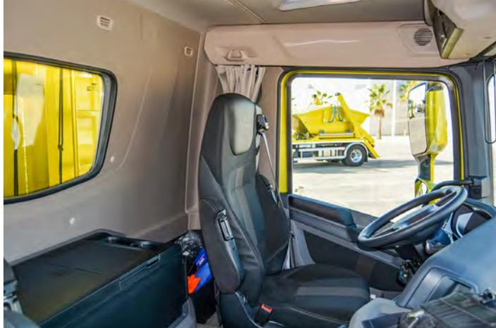
La Day cab "ha crecido" 15 centímetros en su parte trasera, lo que permite ampliar la regulación de la inclinación del asiento. Entre las opciones, está la posibilidad de montar una nevera o un tercer asiento.
