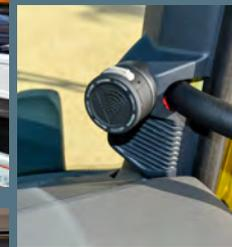
*DAF XD con tercer eje direccional con el sistema DAF City Turn Assist; en las fotos de detalle: el radar delante del segundo eje y el "avisador" en el montante A del lado derecho.*
