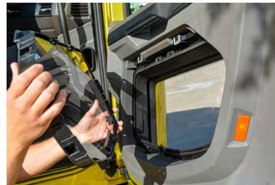
El cristal interior de la puerta se desmonta fácilmente para simplificar las tareas de limpieza.
