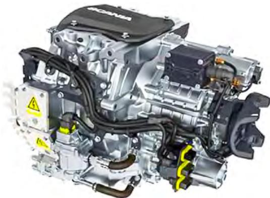
El sistema propulsor GE21S21 que montaba este Scania 25 P está integrado por el motor eléctrico (mitad izquierda) y una transmisión de dos velocidades.
