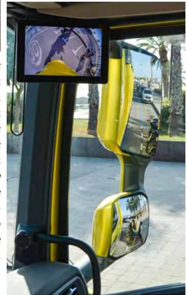
Vision System, el sistema de cámaras, calefactadas y retractiles, que reemplaza a los retrovisores principales. Cuenta con funciones que ayudan a realizar maniobras en los muelles de carga, al tomar curvas y en los adelantamientos. Además, de mejorar la visión directa, la sustitución de los retrovisores por el sistema DAF Digital Vision System reduce la resistencia aerodinámica en un 4,5%, lo que puede mejorar la eficiencia del combustible hasta en un 1,4%.
