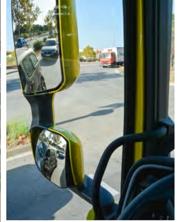
El diseño de las carcasas de los retrovisores principales amplía el campo visual del conductor hacia los laterales y mejora la seguridad, por ejemplo, al acceder a una rotonda.
