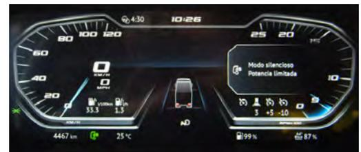
Dos vistas del cuadro de instrumentos: arriba, con el modo silencioso activado, pensado para las operaciones de distribución nocturna, que limita la potencia para hacer menos ruido; abajo, con los pesos por eje.
