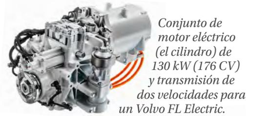
Conjunto de motor eléctrico (el cilindro) de 130 kW (176 CV) y transmisión de dos velocidades para un Volvo FL Electric.
