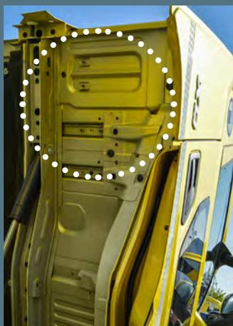
Arriba, detalle del dispositivo del sistema ProCaDis que permite el desplazamiento de la cabina en caso de colisión; a la izquierda, área con deformación controlada, que, si se produce un accidente, absorbe la energía para reducir los daños en el habitáculo.
