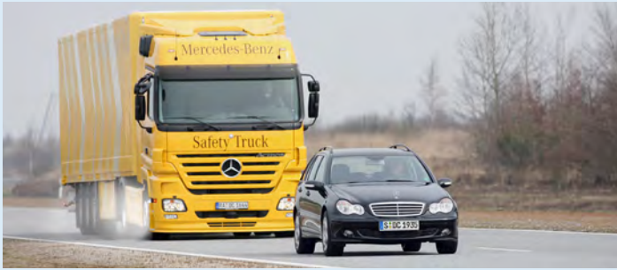
Mercedes-Benz ofrece desde 2002 el sistema de frenado de emergencia, el Active Brake Assist, diez años antes de fuera obligatorio.
