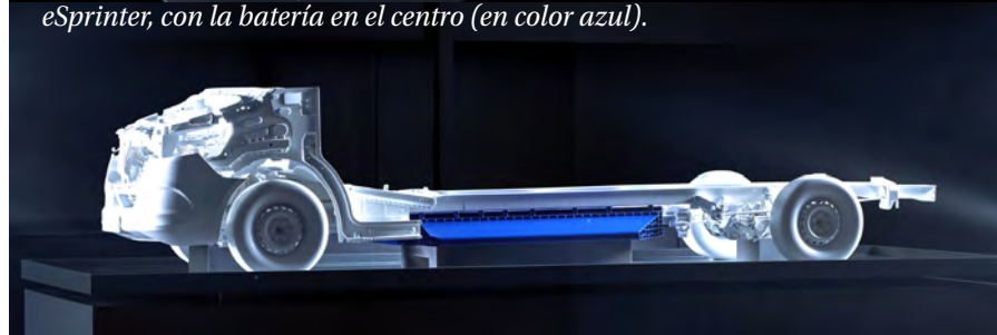
El tren motriz eléctrico (eATS) integra el eje propulsor y el motor eléctrico.
