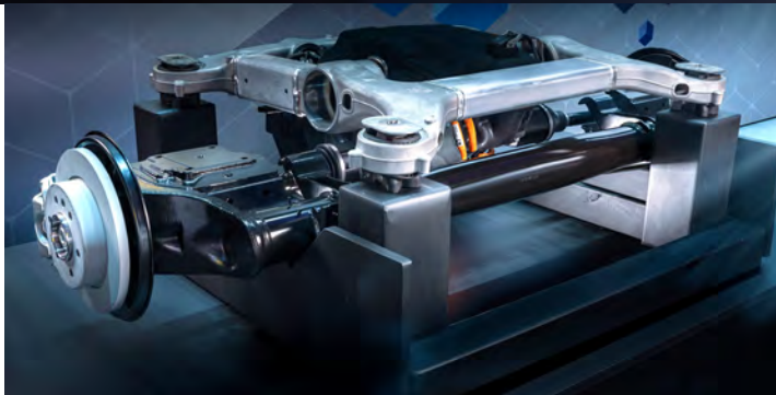
El tren motriz eléctrico (eATS) integra el eje propulsor y el motor eléctrico.
