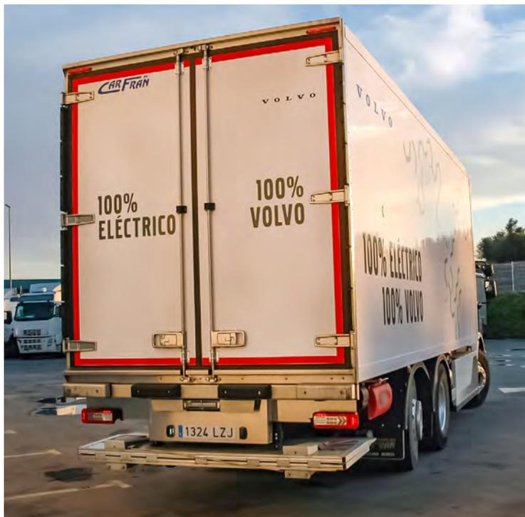
*Esta unidad montaba equipo de frío y trampilla, ambos de accionamiento eléctrico, aunque en el caso de la trampilla la electricidad la suministran unas baterías convencionales de 24 voltios, que recargan las baterías de tracción; el equipo de frío, por su parte, tira directamente de las baterías de tracción.*
