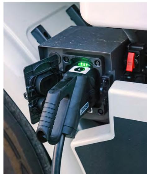
La opción de carga rápida, con corriente continua, permite el "repostaje" de las cuatro baterías en unas dos horas, y en una hora y media con tres; con corriente alterna, se necesitan unas once horas para completar la carga de las cuatro baterías y ocho horas para tres baterías.
