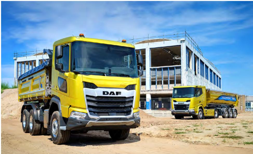
Los camiones de construcción DAF de la Nueva Generación, XDC y XFC, se caracterizan por la parrilla negra, el parachoques de acero robusto, la placa de protección de acero del radiador, las dos luces LED antivuelco integradas en el parachoques para una máxima protección; un peldaño inferior flexible opcional; una distancia al suelo de hasta 40 cm y un ángulo de aproximación de 25 grados. Las configuraciones posibles son 8x4, 6x4 y ahora también 4x2.
