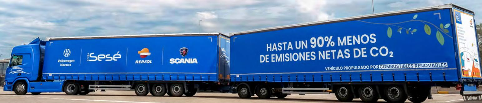
**T**ras el éxito alcanzado en las pruebas con este combustible en conjuntos estándar de tractora y semirremolque, que ya han recorrido más de medio millón de kilómetros, este grupo de empresas pone ahora en circulación un duotrailer, un conjunto integrado por una tractora Scania V8 650 R y dos semirremolques unidos por un “dolly” de dos ejes.
