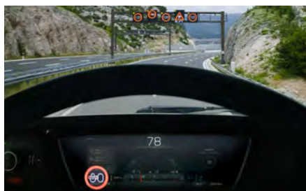
Una cámara "lee" las señales de tráfico para mostrar los límites de velocidad en el panel de instrumentos.
