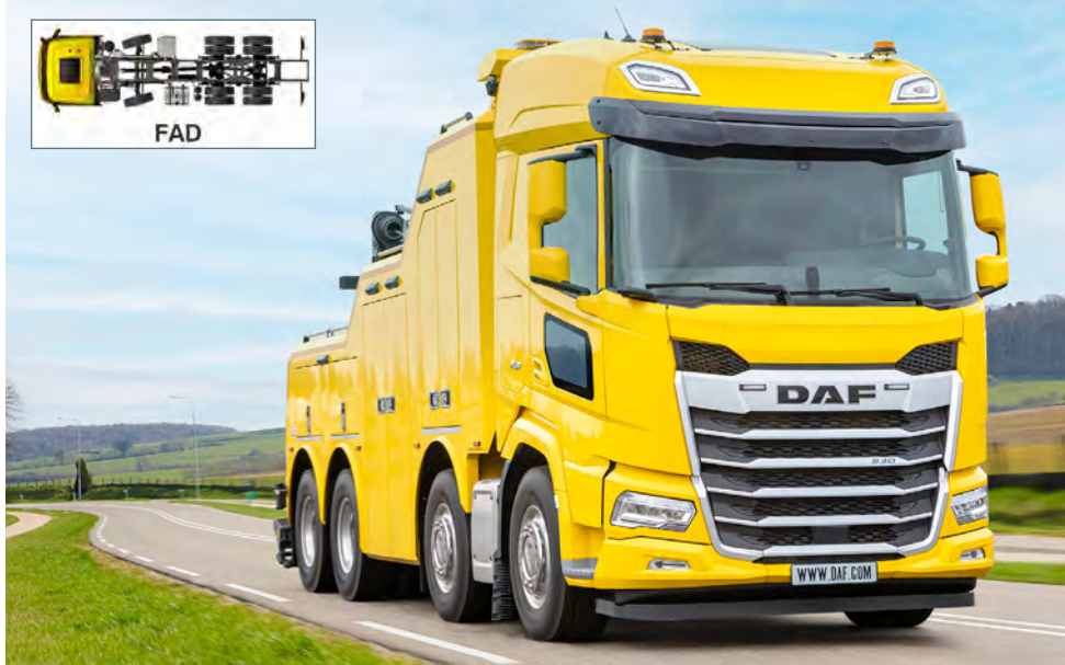
DAF XF 530 FAD preparado como vehículo grúa; abajo, tractora XG+ 530 8x4 con eje impulsor direccional (FTM) y dirección eléctrica en el segundo eje, capaz de arrastrar 120 toneladas o incluso más peso en determinadas circunstancias.
