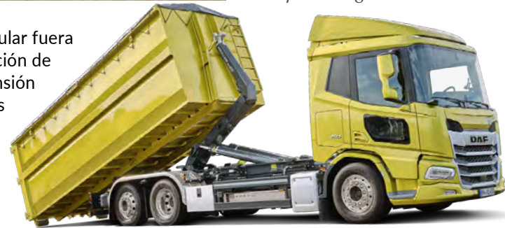
Chasis XD 450 FAN 6x2 con la Sleeper Cab con la puerta del lado derecho acristalada.
