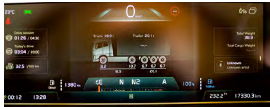
Detalle del reparto de pesos del FH 460 I-Save, con un pequeño problema en el peso de la tractora.
