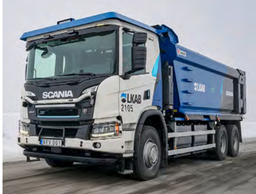
Scania 25 P XT BEV 6x4 con volquete de construcción.
