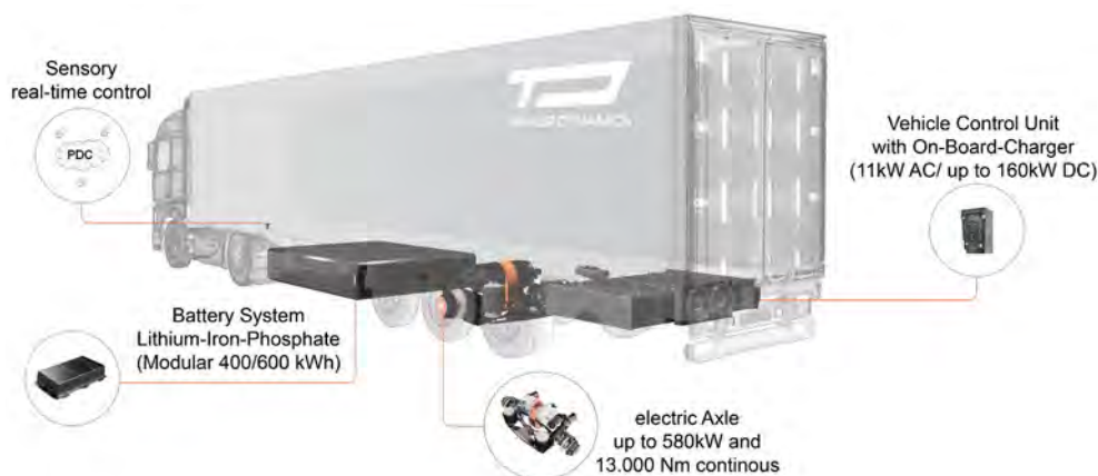
Esquema y dos imágenes detalle del semirremolque de Trailer Dynamics.
