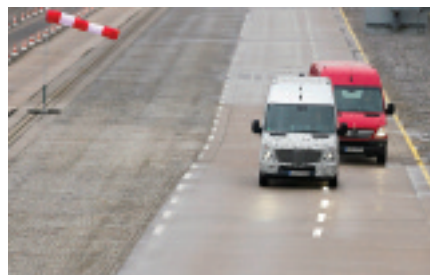
En esta foto podemos observar cómo influye el asistente de viento lateral corrigiendo la trayectoria de la furgoneta que lleva incorporado el sistema, la blanca, cuando atraviesa por una racha fuerte de viento lateral.
